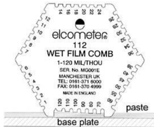
图23、用于测量导热膏层厚度的梳状物
